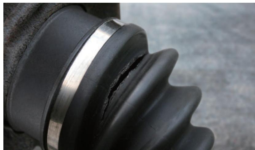
Bota de Junta Homocinética Agrietada
